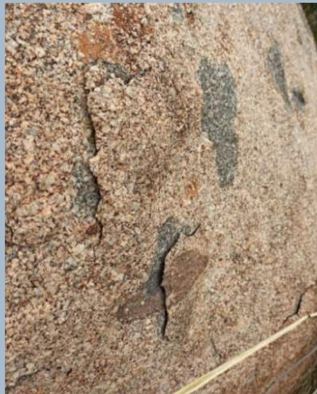
Αποφλοίωση σε ψαμμίτη, έπειτα από έκθεση σε υψηλές θερμοκρασίες λόγω δασικής πυρκαγιάς.
