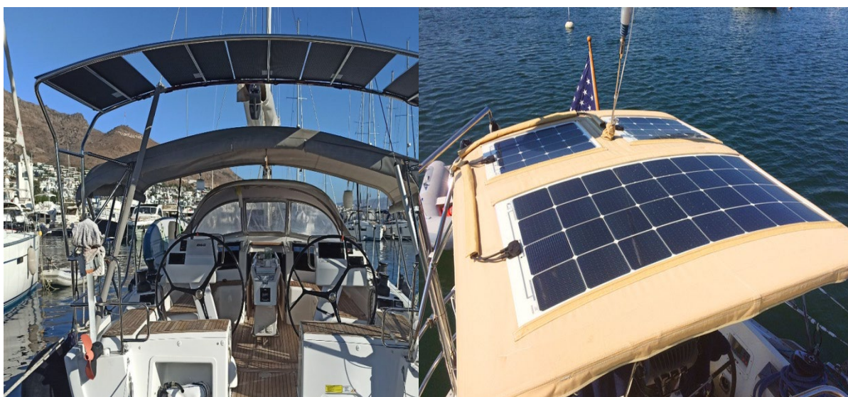
Εικόνες 10: Τοποθέτηση Εύκαμπτων φωτοβολταϊκών σε bimini 12
